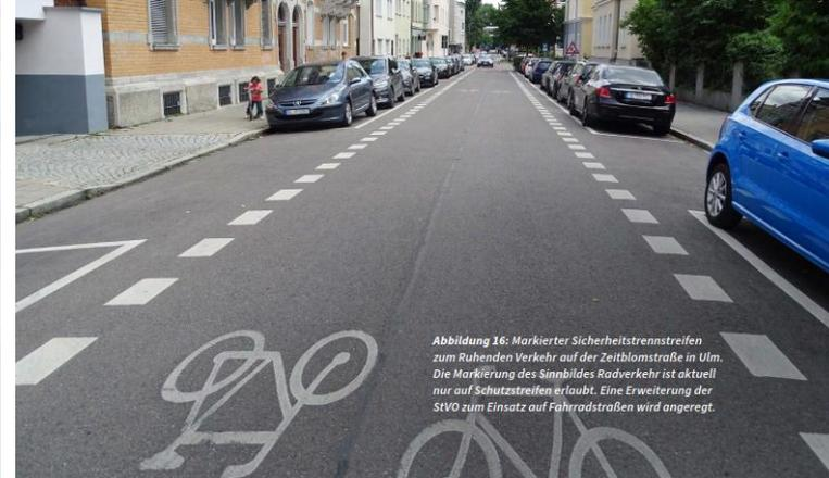
Abbildung 16: Markierter Sicherheitstrennstreifen zum Ruhenden Verkehr auf der Zeitblomstraße in Ulm. Die Markierung des Symbols Radverkehr ist aktuell nur auf Schutzstreifen erlaubt. Eine Erweiterung der StVO zum Einsatz auf Fahrradstraßen wird angeregt.
