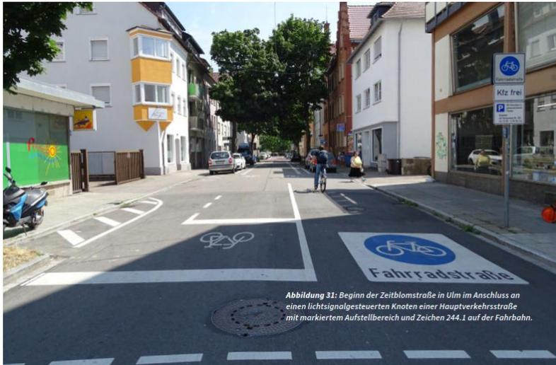
Abbildung 31: Beginn der Zeitblomstraße in Ulm im Anschluss an einen lichtsignalgesteuerten Knoten einer Hauptverkehrsstraße mit markiertem Aufstellbereich und Zeichen 244.1 auf der Fahrbahn.
